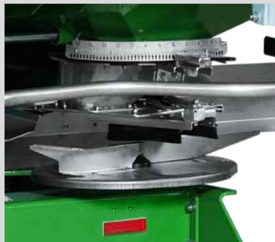
UKŁAD WYSIEWAJĄCY Z WIDOCZNĄ SKALĄ ORAZ SZCZOTKAMI
